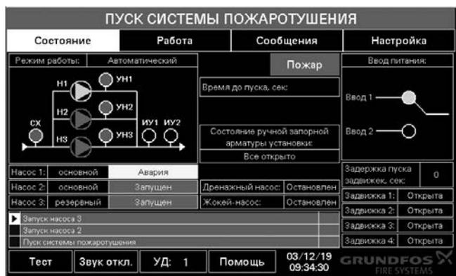
Рис. 10 Вид меню «Состояние» при поступлении сигнала на запуск
