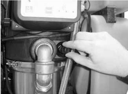
Fig. 13 Vis de purge d'air de la pompe
