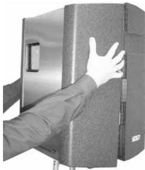
Fig. 3 Retrait de la façade de l'armoire
