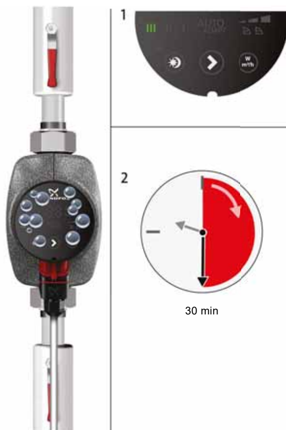
Afb. 8 De pomp ontluchten
