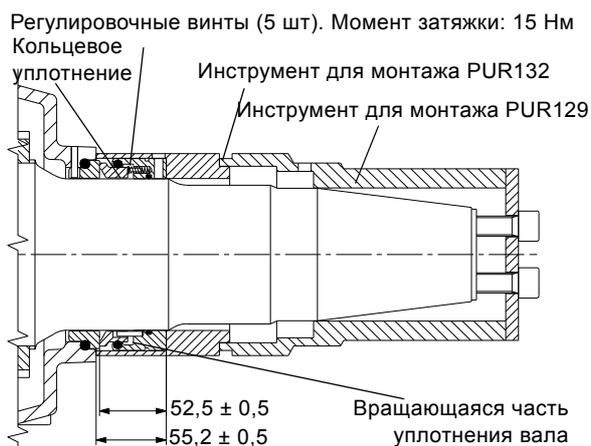
**Рис. 40** Установка вращающейся части вторичного уплотнения вала, типоразмер 78
