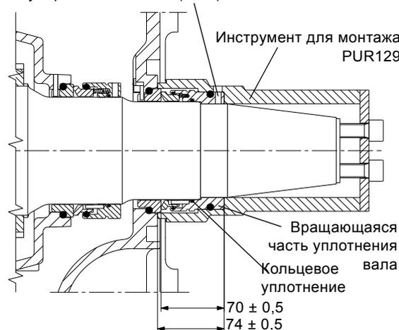
**Рис. 42** Установка вращающейся части первичного уплотнения вала, типоразмер 78
