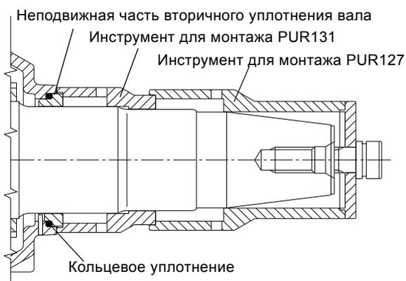
Рис. 34 Установка неподвижной части вторичного уплотнения вала, типоразмер 74
