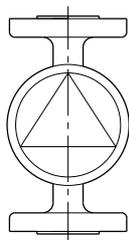
Рис. 32 Схематическое изображение насоса LS типа "ин-лайн"
