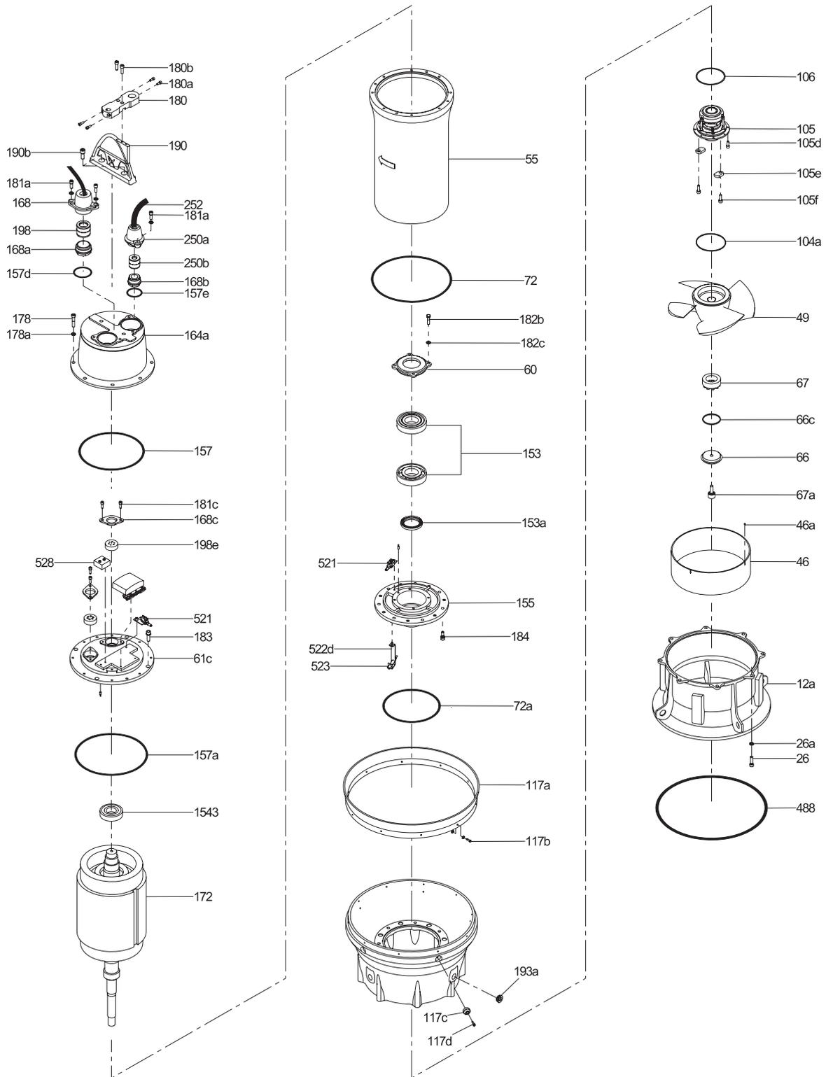
Рис. 13 Деталировка, KPL, обсадная труба DN 600–650
