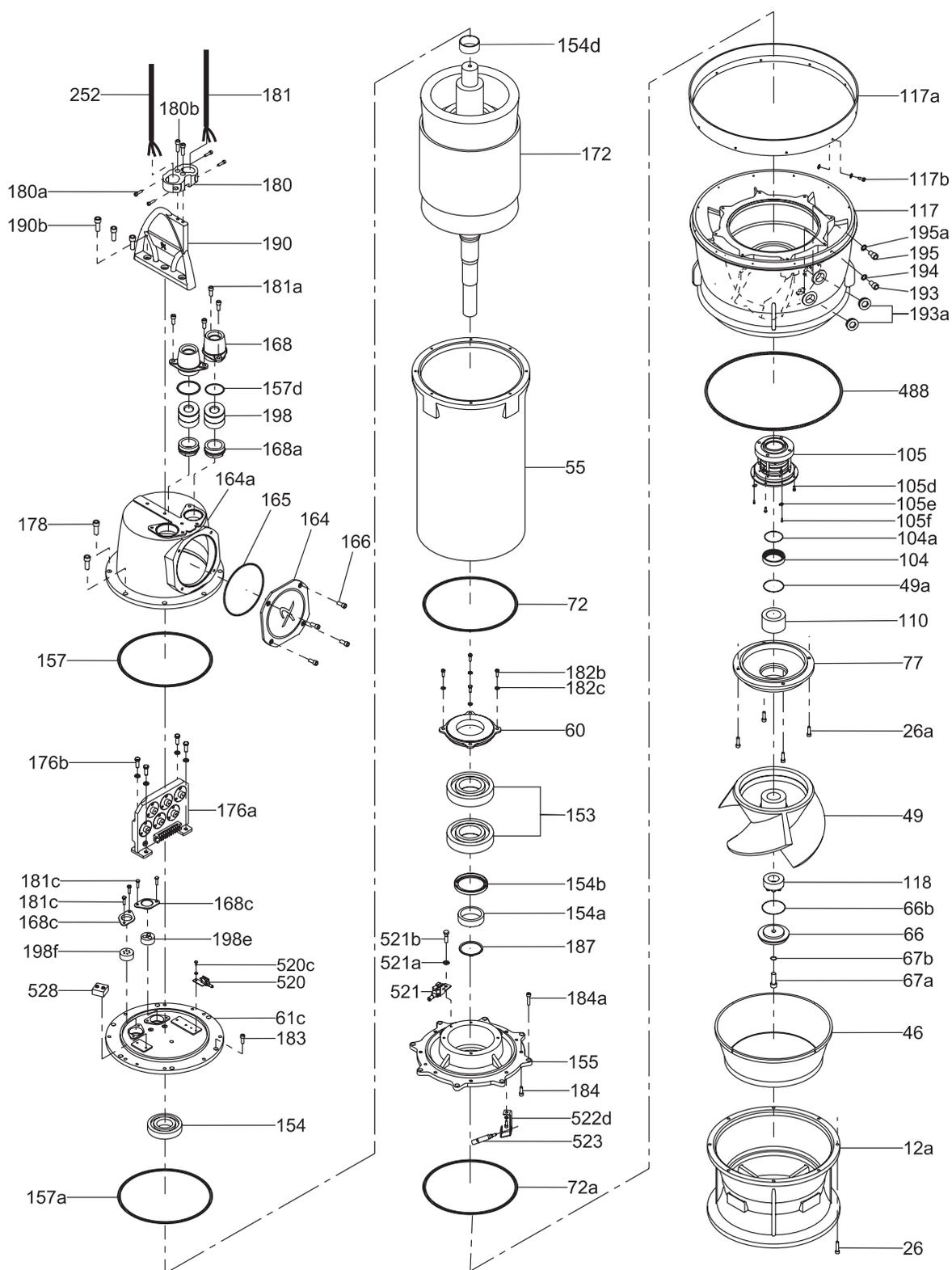
Рис. 20 Детализовка, KWM, обсадная труба DN 600–700
