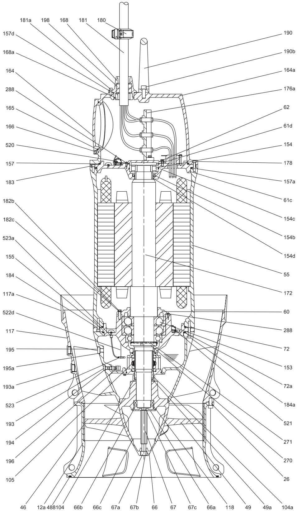
Рис. 11 Чертеж в разрезе, KPL, обсадная труба DN 1000–1800
