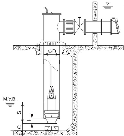
Рис. 45 Монтажные размеры, насос KWM, антикавитационный конус установлен
