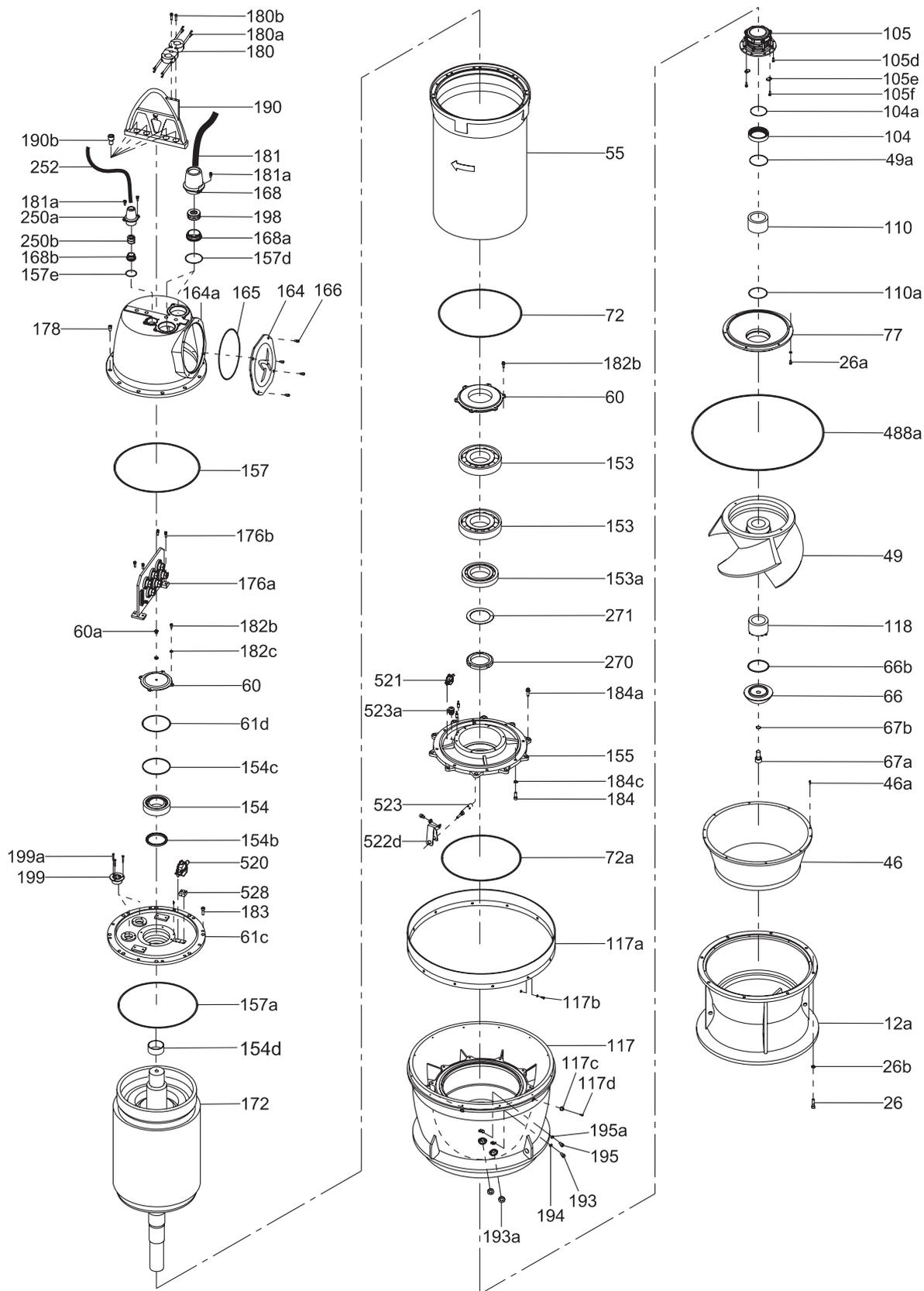
Рис. 21 Детализовка, KWM, обсадная труба DN 800–1600
