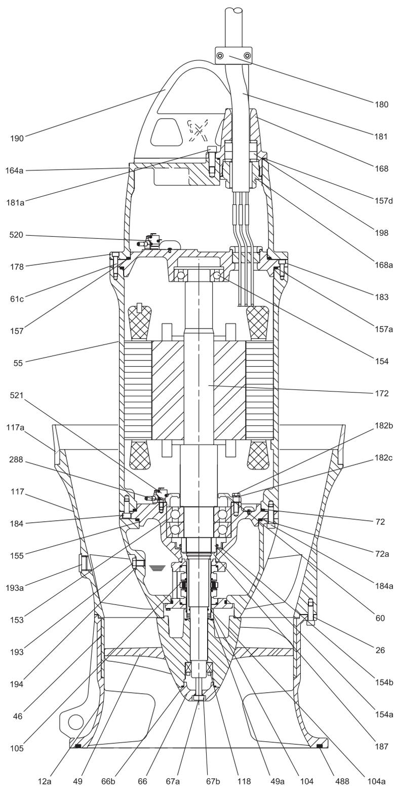
Рис. 6 Чертеж в разрезе, KPL, обсадная труба DN 500
