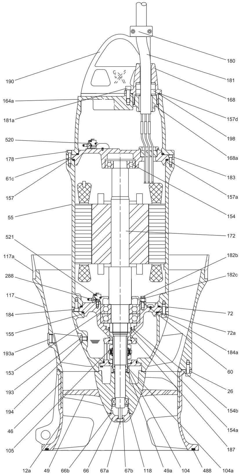
Рис. 7 Чертеж в разрезе, KPL, обсадная труба DN 600
