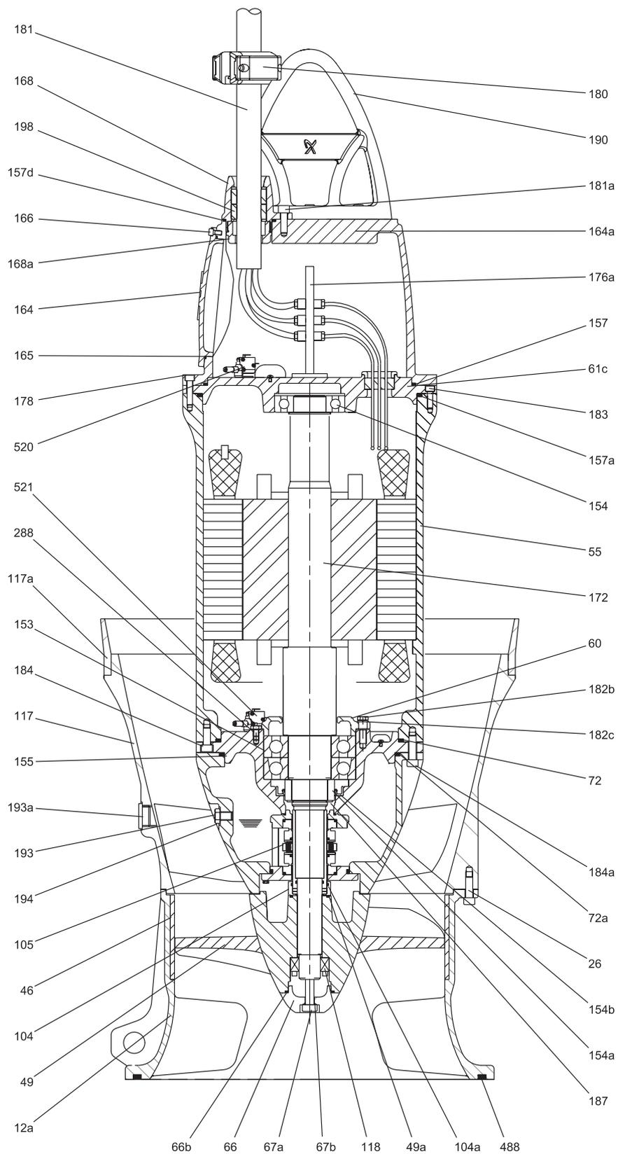
Рис. 8 Чертеж в разрезе, KPL, обсадная труба DN 650
