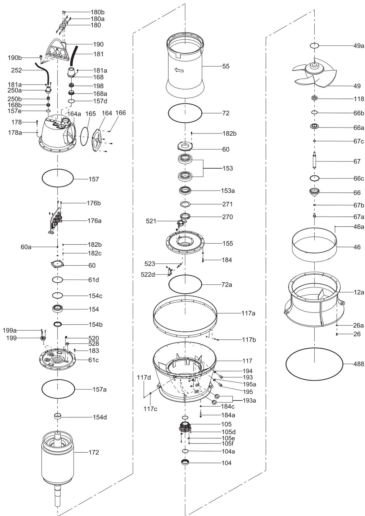
Рис. 15 Детализовка, KPL, обсадная труба DN 900–1800
