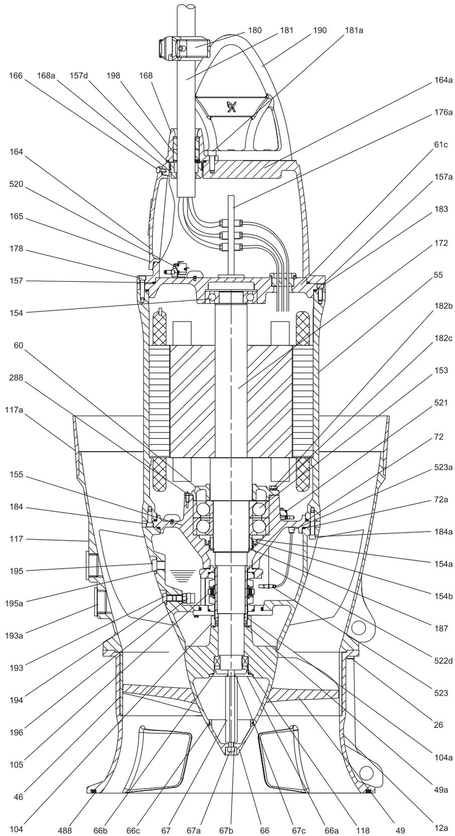
Рис. 9 Чертеж в разрезе, KPL, обсадная труба DN 700–800
