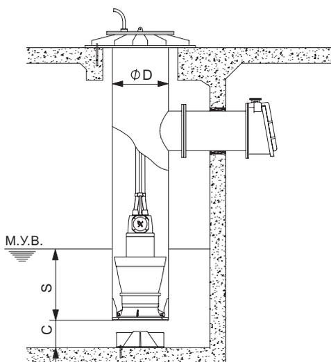
Рис. 39 Монтажные размеры, насос KPL, антикавитационный конус установлен
