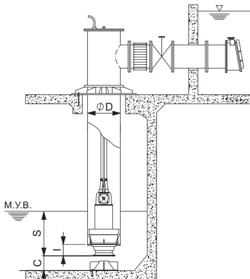
Рис. 44 Монтажные размеры, насос KWM, антикавитационный конус установлен
