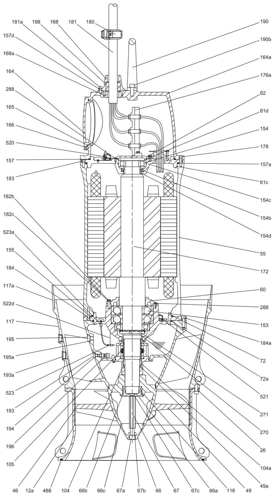
Рис. 10 Чертеж в разрезе, KPL, обсадная труба DN 900
