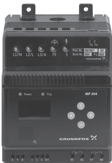
Устройство MP 204 можно использовать как отдельный блок защиты электродвигателя. Устройство MP 204 может быть встроено в систему Grundfos Dedicated Controls в качестве защиты электродвигателя. Во вторую очередь выполняется защита насоса путем измерения температуры с помощью датчика Pt100 и датчика РТС или термовыключателя.
