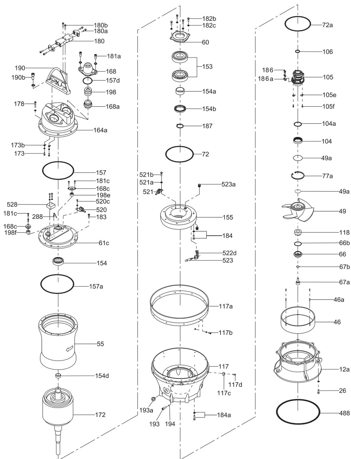
Рис. 12 Деталировка, KPL, обсадная труба DN 500
