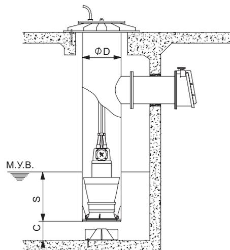
Рис. 40 Монтажные размеры, насос KPL, антикавитационный конус установлен
