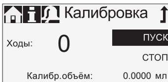
5. Насос выполняет 200 ходов дозирования и отображает значение заводской калибровки (например, 1,05 л).
