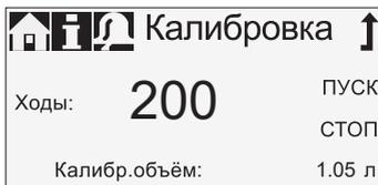
6. Вытащите всасывающий шланг из мерного стакана и проверьте оставшийся объем V2 (например, 1,39 л).
