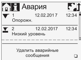
Неисправности, перечисленные в конце данного списка, можно удалить.
