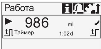
Рис. 32 Ежедневное дозирование по таймеру (перерыв в дозировании)
