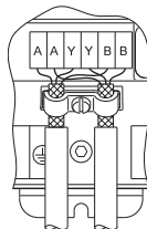
Fig. 6 Blindage fixé avec l'attache-câble
