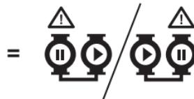
Eine Pumpe läuft im Dauerbetrieb. Die Reservepumpe wird in bestimmten Abständen betrieben, um ein Blockieren der Pumpe zu verhindern. Falls die Betriebspumpe aufgrund einer Störung ausfällt, schaltet sich die Reservepumpe automatisch ein.
