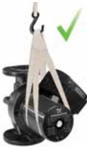
图 7 水泵的正确吊装
