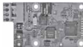
Fig. 21 Grundfos CIM communication interface module
