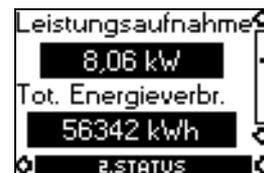
Auf dieser Bildschirmseite werden die aktuellen Werte für die Leistungsaufnahme und den Energieverbrauch des Motors angezeigt.
