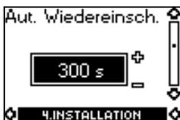
Auf dieser Bildschirmseite kann die Zeit eingestellt werden, nach der das MP 204 nach einem Abschalten des Motors einen Neustart durchführen soll.
