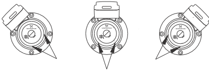
Abb. 2 Klemmenkastenstellungen für Einzelpumpen
