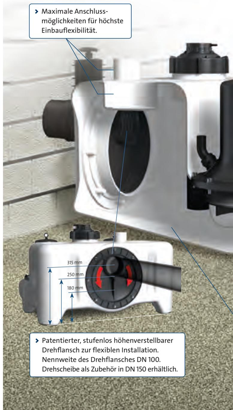
► Patentierter, stufenlos höhenverstellbarer Drehflansch zur flexiblen Installation. Nennweite des Drehflansches DN 100. Drehscheibe als Zubehör in DN 150 erhältlich.
